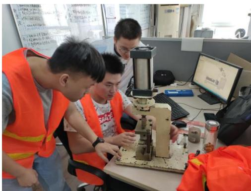
图1 学生参与东风派恩公司技术部压装机的设计与制作
