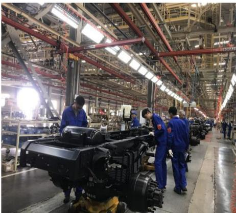
图 3 车架管路装配质量的检测操作
